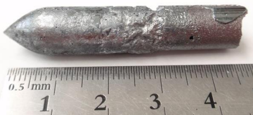
図 2 CAZTS 単結晶インゴットと熱電変換効率測定の様子
